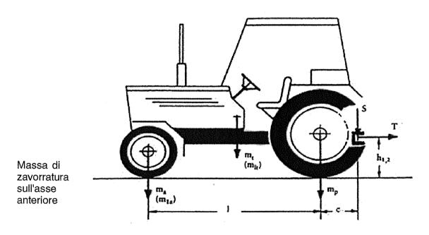
3.4.1. Tutti i trattori aventi una massa a pieno carico superiore a 2,5 tonnellate devono essere muniti di un dispositivo di accoppiamento, la cui altezza dal suolo è conforme a una delle due formule seguenti:
